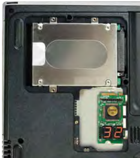
204 0508—Laptop model; plugs into a Mini PCI or Mini Card PCI-E slot
